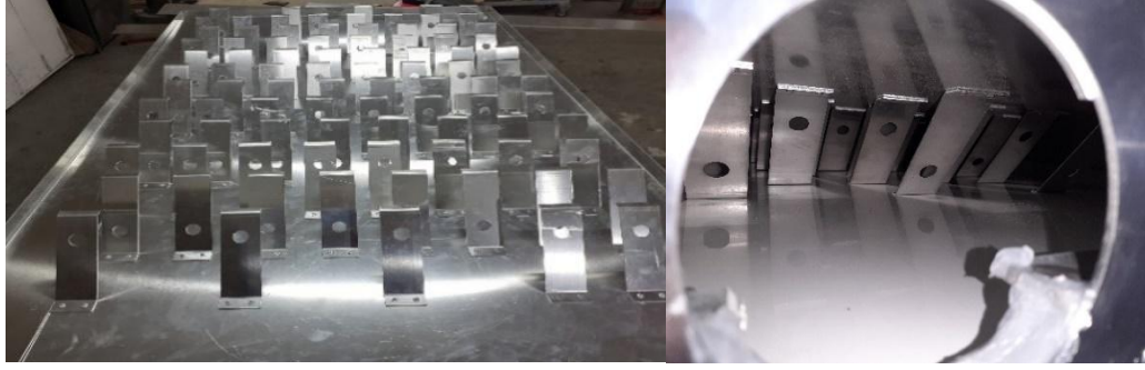
Şekil 2.12. Dikdörtgen kesitli ısı eşanjörü imalatı
