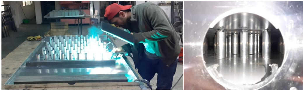
Şekil 2.11. Dairesel kesitli ısı eşanjörü imalatı
